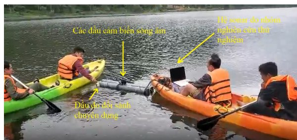
Hình 5. Hình ảnh thử nghiệm hệ Sonar chủ động quét hình ảnh đáy 2D tại hồ Đồng Đò ngày 16 tháng 10 năm 2021
